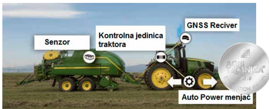
■ Slika 2. Inteligentno prigušivanje vibracija u radu sa velikim kvadarnim balama John Deere & Co.,
