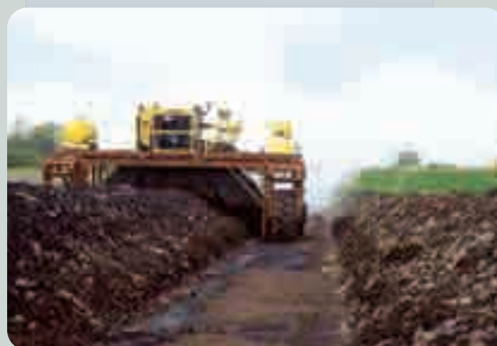
Mehanizovano mešanje komposta u toku fermentacije organske materije
