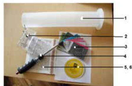
■ Slika 6: Pomoćna oprema za izbor radnih parametara raspodeljivača: 1 – menzura zapremine 2 L za merenje gustine, 2 – posuda sa sitima za određivanje granulometrijskog sastava, 3 – etalon slike najčešće primenljivanih đubriva za upoređivanje, 4 – penetrometar za merenje otpornosti granula na sile razaranja, 5 i 6 – tablice ili šiberi za izbor radnih parametara
