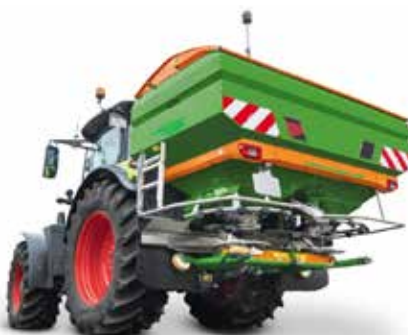
■ Slika 1: Savremeni centrifugalni rasipač sa dva diska opremljen za tehnologiju primene promenljivih količina (Variable Rate Technology (VRT)), za uslove rada sa povećanim intenzitetom vetra i rad na granicama parcela
