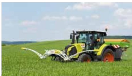
■ Slika 8: Agregat za prihranu sa nosačem i senzorima „potrebe za azotom“
