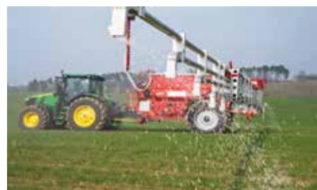
■ Slika 2: Savremeni pneumatski raspedeljivač opremljen za tehnologiju primene promenljivih količina (Variable Rate Technology (VRT))
